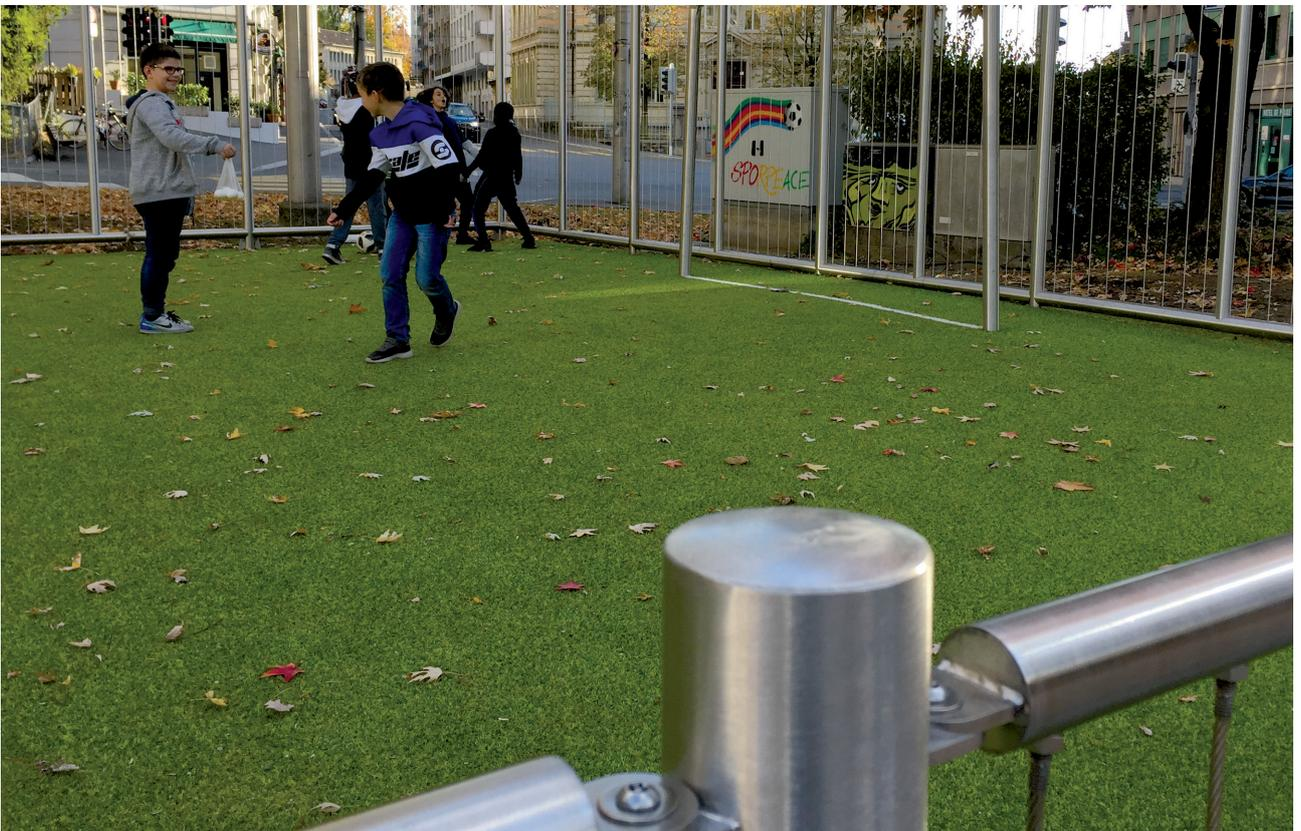
Le gazon synthétique ne nécessite pas obligatoirement un enrobé. Il peut être posé sur une planie réglée avec minutie. Une sous-couche de souplesse et de confort peut être placée entre le support et le gazon synthétique. Pour un usage en Sports-Loisirs, elle n'est pas systématiquement appliquée.
